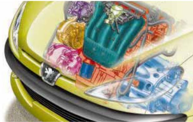
● Le moteur 2.0 l / 16 soupapes 138 ch concilie souplesse et tonicité grâce à un couple qui atteint 191 Nm à 4100 tr/min.
