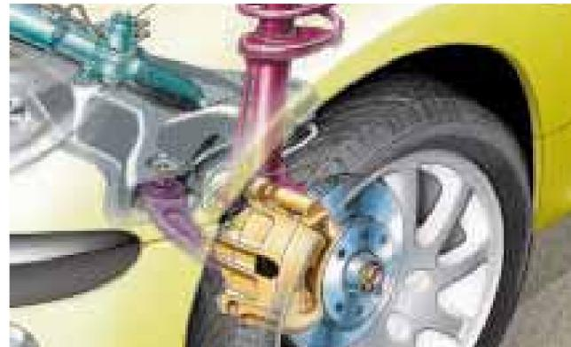
● Les suspensions avant sont de type pseudo Mac-Pherson inversé avec barre anti-dévers découplée. Les trains arrière à bras tirés possèdent des articulations de bras sans jeu. Équipée d'un freinage de haut niveau, la 206 CC offre de série l'ABS et 4 freins à disques dont 2 ventilés à l'avant.
