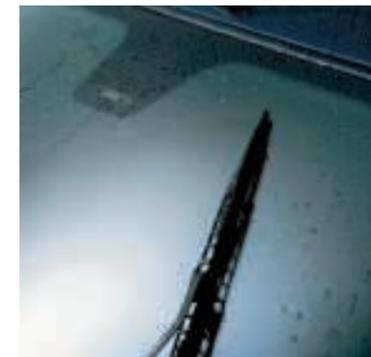
**Le système de détection de pluie<sup>(2)</sup>** déclenche le fonctionnement des essuie-glace et adapte la vitesse de balayage à l’intensité de la pluie.
