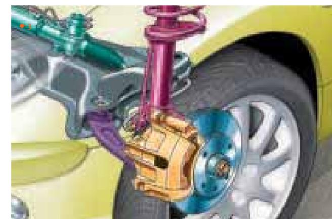
3 Les suspensions avant sont de type pseudo Mac-Pherson inversé avec barre anti-dévers découplée. Les trains arrière à bras tirés possèdent des articulations de bras sans jeu. Équipée d'un freinage de haut niveau, 206 CC offre de série l'ABS multiplé et 4 freins à disques dont 2 ventilés à l'avant.
